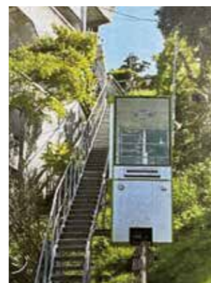
スロープカーのイメージ (住民説明会資料より)
